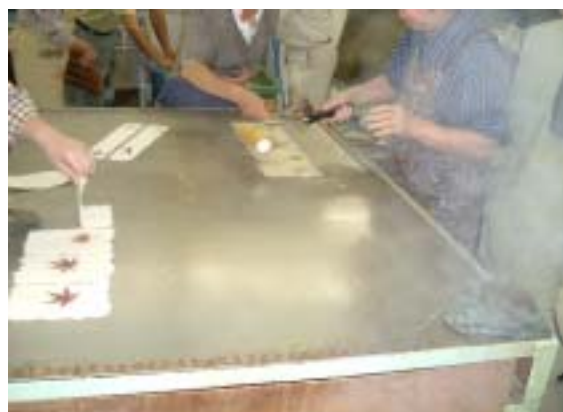
ケナフの紙をホットプレートで乾燥している
