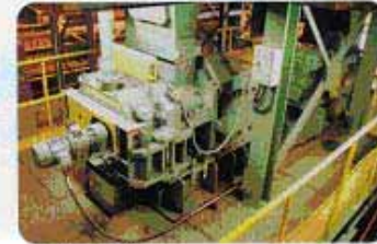
ウレタン減容機 冷蔵庫の断熱ウレタンからフロン、シクロペンタンを分離回収します。
