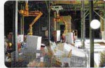
冷蔵庫手分解ヤード コンプレッサー、プラスチック、冷媒フロンなどを回収します。
