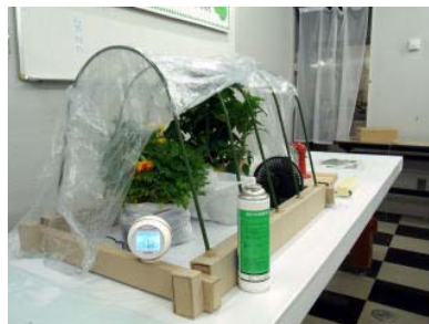
光合成実験装置（手前が CO 2 計測器）
