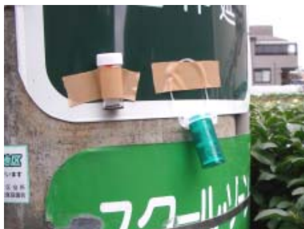
図 2 B および C 方式の測定管を 取り付けている様子
